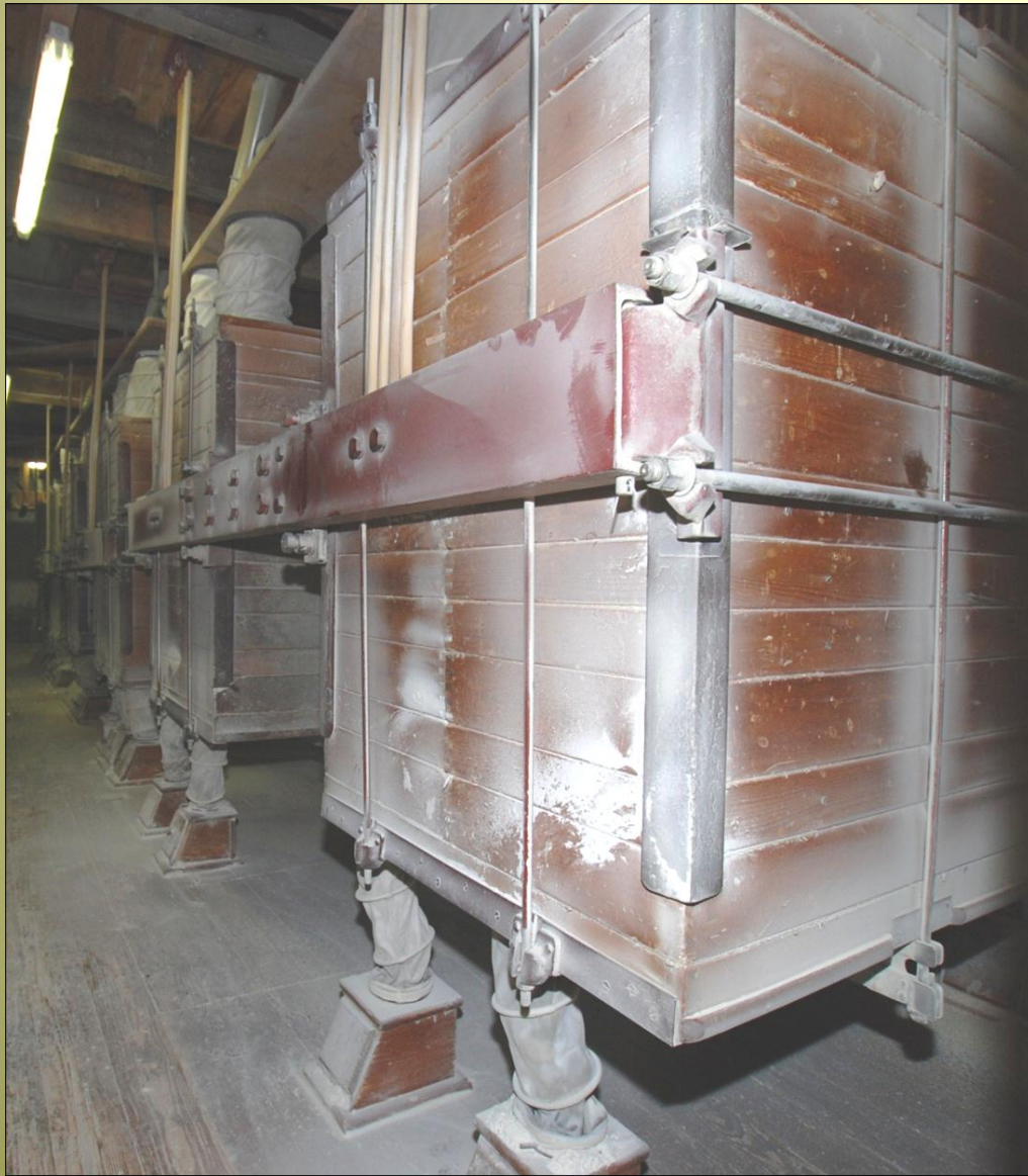
Des tamis vibrants séparent la farine et le son.
